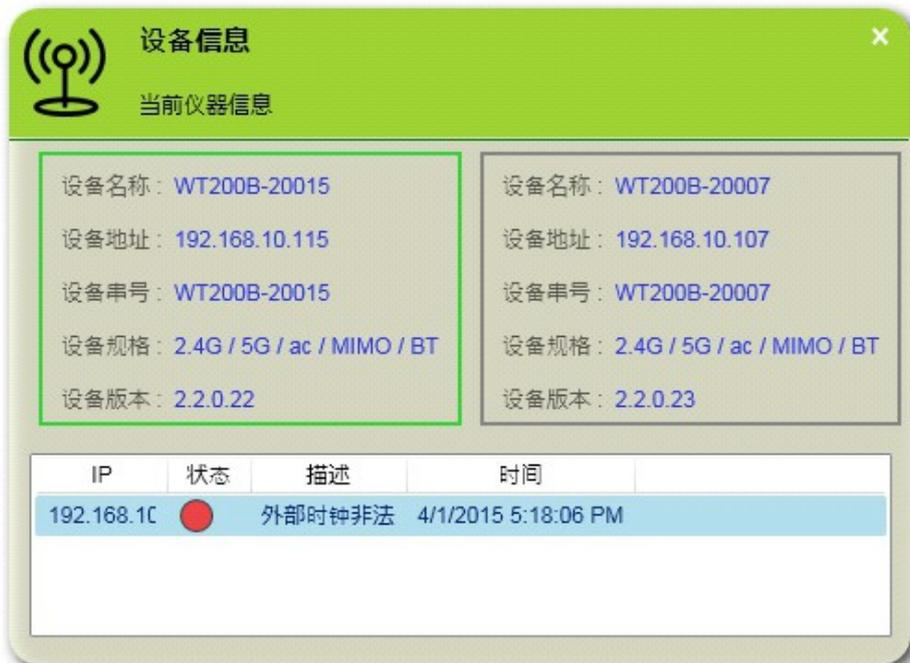
图 3-22 WLAN Meter 设备信息错误查看界面
