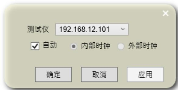
图 3-7 WLAN Meter 参考时钟配置
