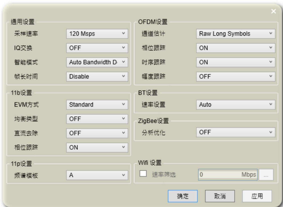
图 3-8 WLAN Meter 默认分析参数
