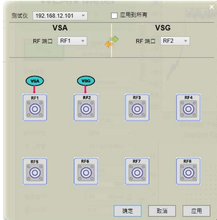
图 3-6 WLAN Meter 配置 WT-20X RF 端口的工作模式
