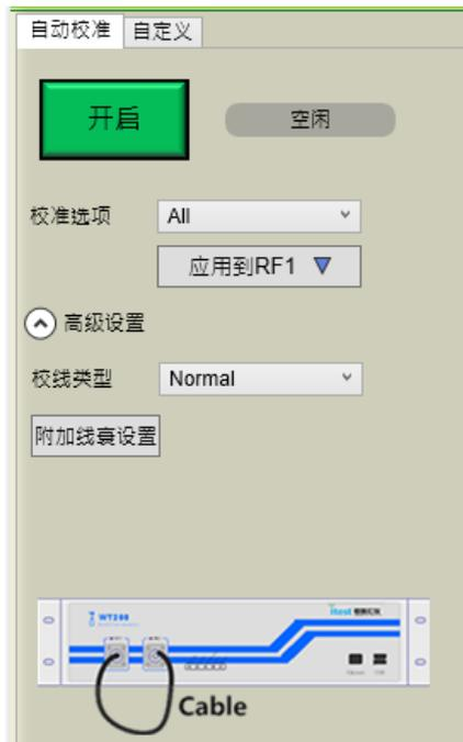
图 3-16 Normal 方式校线示意图
